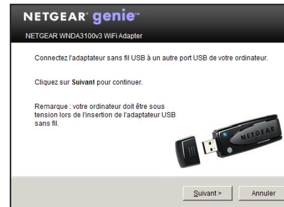
5. Insérez l'adaptateur dans un port USB de votre ordinateur avec ou sans le câble USB et le support en plastique.
