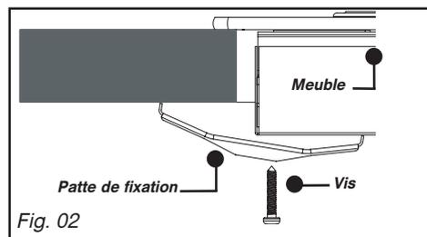
– Vous pouvez immobiliser, si vous le désirez, la table au moyen de pattes de fixation livrées avec leur vis (Fig. 02) se fixant sur le carter aux emplacements repérés **A**. (Fig. 01) prévus à cet effet.
