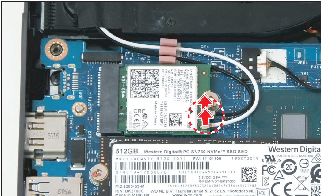
Figure 1-8. Débrancher les câbles de l'antenne WLAN
