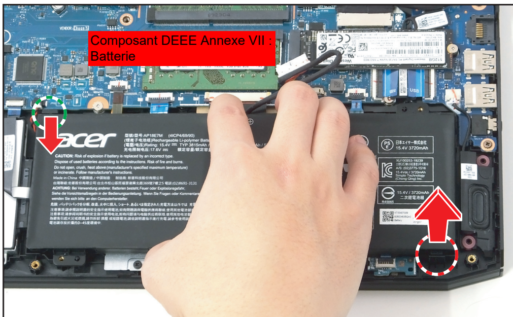
Figure 1-7. Retirer la batterie
