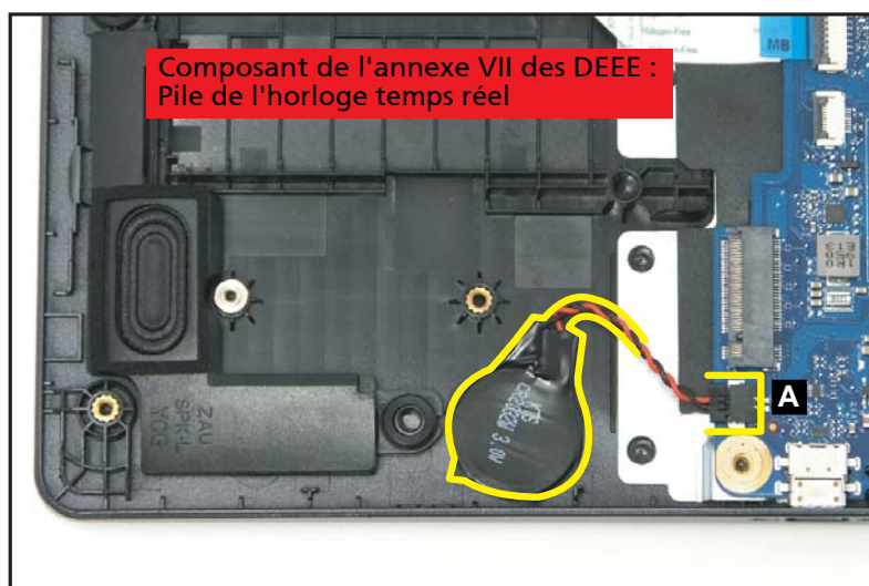
Figure 1-23. Retrait de la pile de l'horloge temps réel
