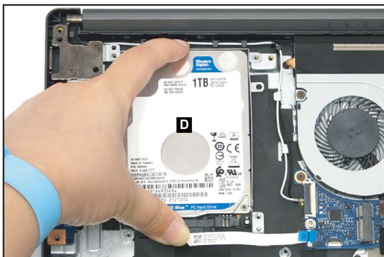
Figure 1-25. Retrait du module disque dur
