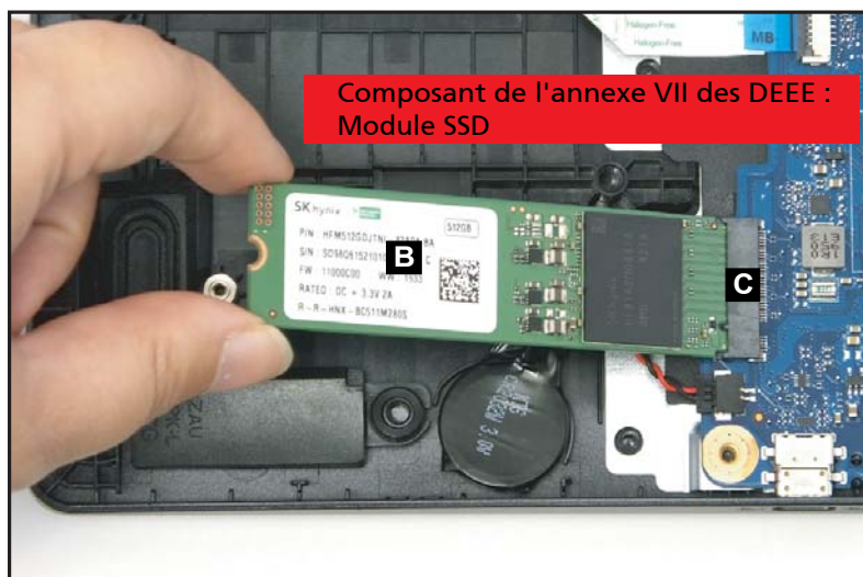
Figure 1-17. Retrait du module SSD
