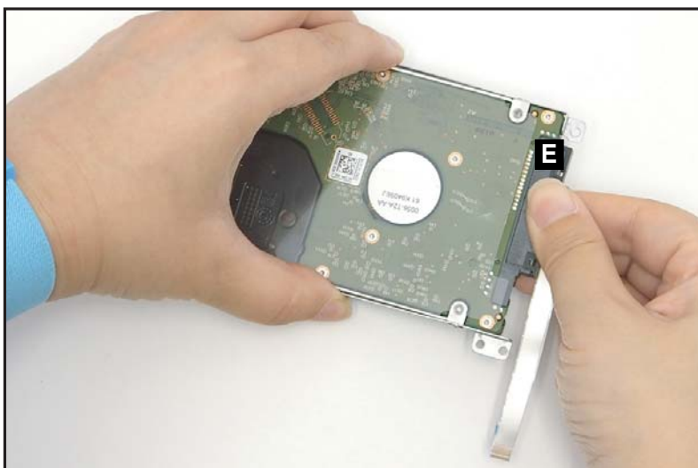
Figure 1-26. Retrait du module disque dur
