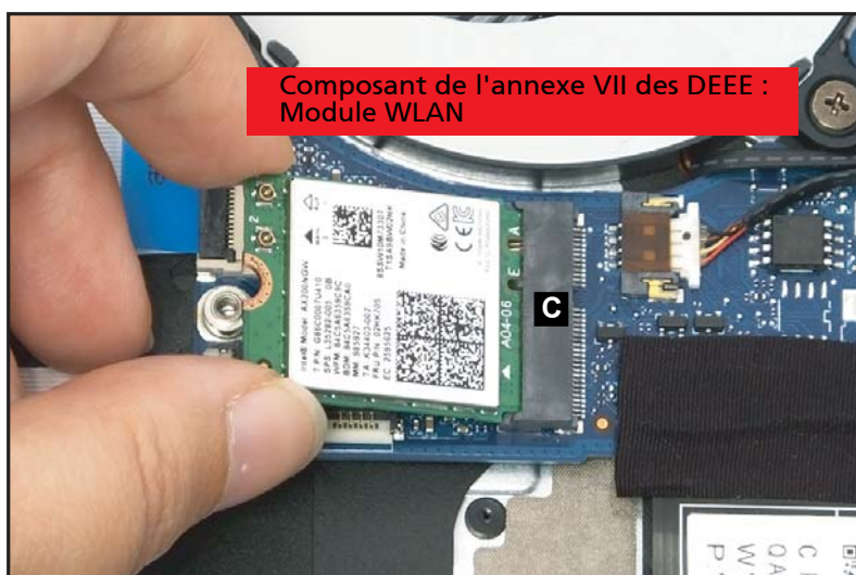
Figure 1-10. Retrait du module WLAN
