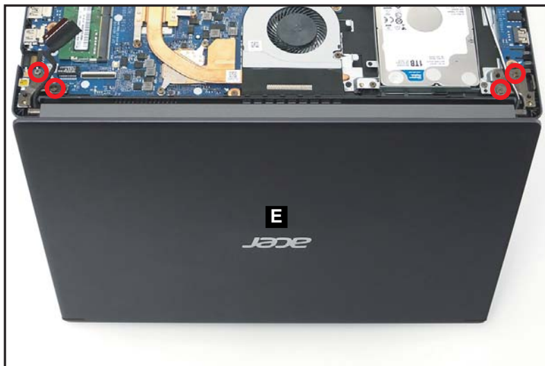
Figure 1-12. Retrait du module LCD
