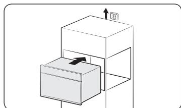
**1.** Insérez partiellement le four dans la cavité. Raccordez le câble de branchement à la source d'alimentation.
