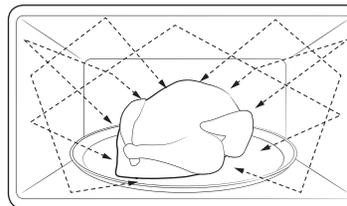
1. Les micro-ondes générées par le magnétron sont réparties de manière uniforme au moyen d'un répartiteur tournant. C'est pourquoi les aliments sont cuits de façon uniforme.
