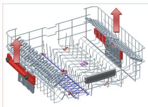
Le mécanisme de réglage de la hauteur du panier supérieur de votre machine a été conçu pour vous donner la possibilité d'ajuster la hauteur de ce panier supérieur vers le haut ou vers le bas, sans l'enlever de la machine lorsqu'il est plein. Et créer ainsi des espaces plus grands ou plus petits entre les paniers supérieur et inférieur. Le panier de votre machine a été réglé à la position supérieure en réglage d'usine.
