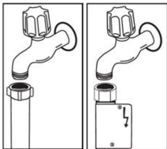
**NB** :Certains modèles utilisent un système Aquastop. Si votre lave-vaisselle est équipé de ce système, il y a du courant avec une tension dangereuse. Ne coupez jamais l'embout Aquastop et veillez à ce qu'il ne soit pas plié ou tordu.
