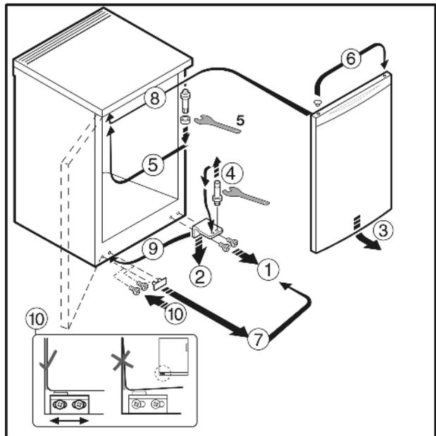
Fig. 5 pour les appareils sans poignée de porte
