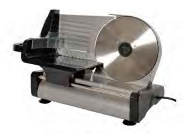
180 watts, 220-240 Volts~50 Hz Diamètre du disque trancheur 22 centimètres Epaisseur maximum de coupe 15 millimètres Chariot amovible.
