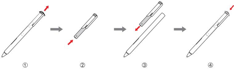
**Remarque :** Insérez la batterie en veillant à respecter la polarité. Faites coïncider les bornes + et - de la batterie aux bornes + et - à l'intérieur du compartiment de la batterie.
