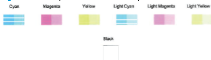
Figure 8-2 Exemple de blocs de couleur présentant des défauts
