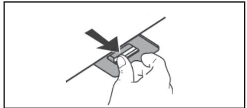
Le filtre à charbon de bois activé ne doit pas être nettoyé, est irremplaçable et doit être remplacé tous les 4 mois d'utilisation ou plus souvent en cas d'utilisation particulièrement intensive.
