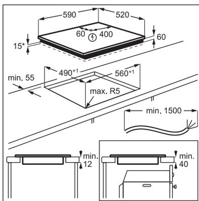
**i** Si l'appareil est installé au-dessus d'un tiroir, la ventilation de la table de cuisson peut chauffer les éléments rangés dans le tiroir durant la cuisson.
