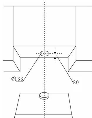
l'intérieur de l'unité murale. Raccorder un tube flexible à la bride de la hotte en utilisant un collier de serrage métallique. Le tube et les colliers de serrage ne sont pas fournis.
