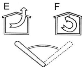
Pour passer en version évacuation, placer le levier sur le symbole E. Puis dégager une sortie d'air au-dessus ou à l'arrière. Installer l'adaptateur de sortie d'air avec clapet anti-retour.
