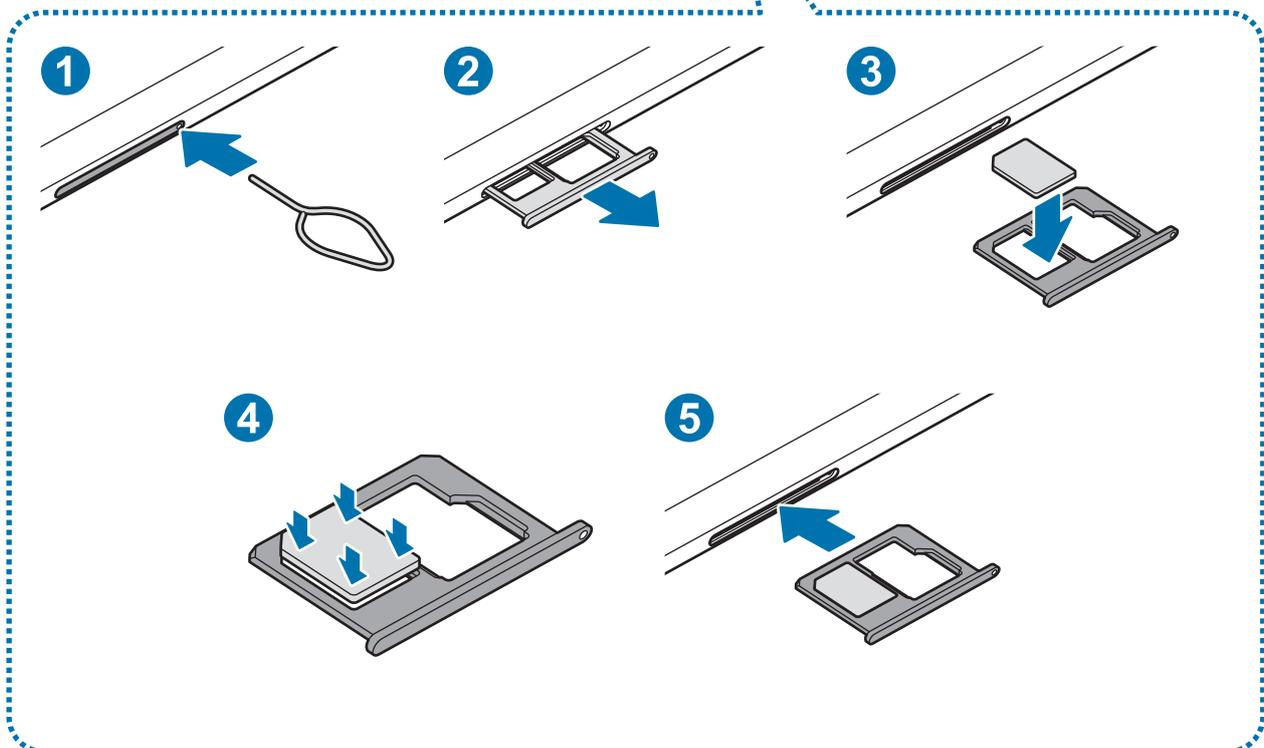
1 Insérez l'outil de retrait à l'endroit prévu à cet effet sur le compartiment pour le déverrouiller.
