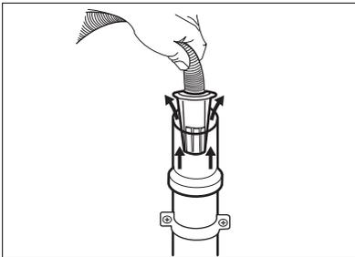
5. **Sans le guide de tuyau en plastique, vers un siphon d'évier -** Placez le tuyau de vidange dans le siphon et fixez-le avec une attache. Reportez-vous à l'illustration.
