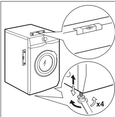
L'appareil doit être de niveau et stable.
