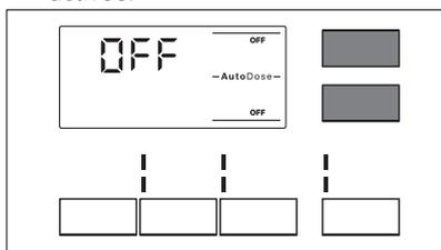
5. Pour régler le dosage de base, appuyez sur les touches correspondant aux réservoirs jusqu'à ce que le dosage de produit de lavage et deux flèches s'affichent en bas de l'écran. Appuyez à plusieurs reprises sur la touche Température pour augmenter le dosage, et sur Option pour le diminuer. Le minimum est de 1 ml.
