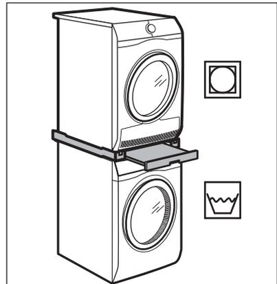
Le sèche-linge ne peut-être superposé au-dessus du lave-linge **qu'en utilisant le kit de superposition adapté, fabriqué et agréé par AEG.**
