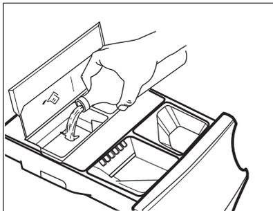
4. Versez doucement un assouplissant liquide uniquement, dans le réservoir AutoDose pour l'assouplissant
