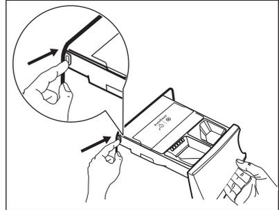
2. Retirez l'insert pour l'assouplissant et, s'il est en place, le récipient pour la lessive liquide.
