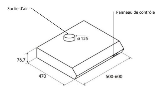
La hotte peut être utilisée en version aspirante à évacuation extérieure, ou filtrante à recyclage intérieur.
