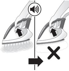
En outre, pour protéger la centrale vapeur du calcaire, la fonction vapeur est désactivée si le traitement anticalcaire n'est pas réalisé. La fonction vapeur est réactivée après le traitement anticalcaire. Le traitement anticalcaire est nécessaire quel que soit le type d'eau utilisé.
