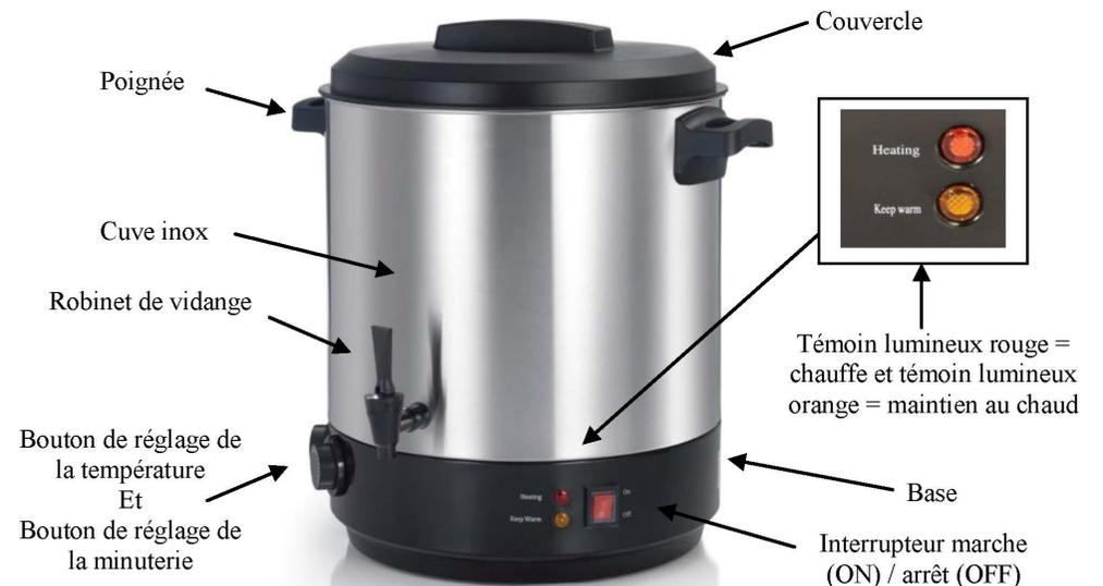
**Cet appareil est équipé d'une protection contre la surchauffe. Cette sécurité se déclenche lorsque l'appareil surchauffe. Pour réarmer l'appareil, il faut attendre qu'il refroidisse complètement, débrancher l'appareil de la prise murale et appuyer fermement sur la tige située au centre sous la base de l'appareil... ne pas appuyer trop fort car la tige ne doit pas s'enfoncer dans la base de l'appareil (déplacement de quelques mm... une tige enfoncée n'est pas couverte par la garantie)**
