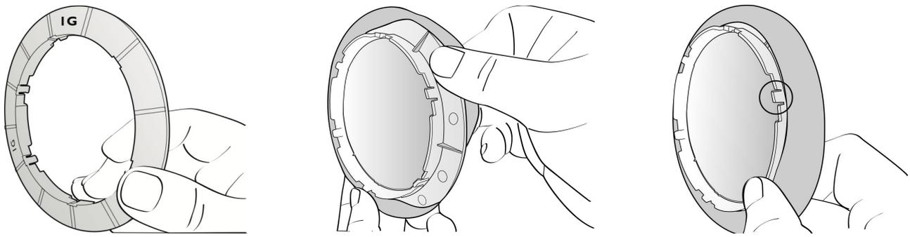
③ Fixer les 2 supports de Pads sur sur le dessous du robot. Les supports de Pads se fixeront aisément sur le robot en faisant correctement coïncider les 6 pattes du support de Pads avec les encoches du compartiment d'accueil.
