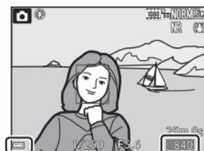
Indicateur du niveau de charge de l'accumulateur
