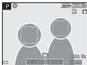
Si plusieurs visages sont détectés, une double bordure apparaît autour du visage sur lequel l'appareil photo effectue la mise au point, et des bordures simples apparaissent autour des autres visages.
