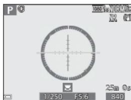
L'appareil photo est dans une position normale pour les sens du roulis et du tangage.
