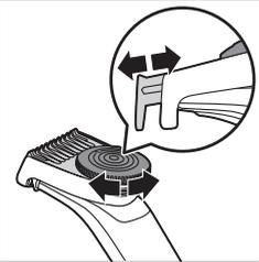
**2** Tournez la molette de réglage de la hauteur de coupe pour sélectionner le réglage de la hauteur de coupe souhaité.
